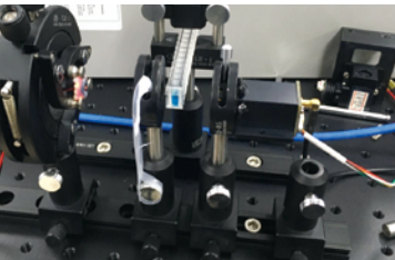
진단 시약 흡광도 및 검출 테스트
