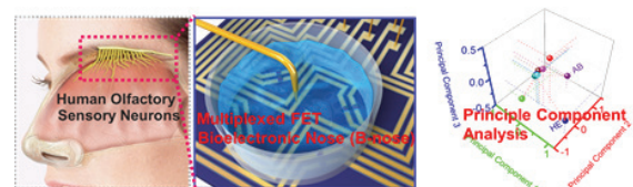
그림 2. 복잡한 인각후각시스템을 그래핀 마이크로 패턴 전계효과트랜지스터기술로 재현하였으며, 주성분 분석(principle compoinen analysis: PCA)법을 통하여 다중 검출 데이터를 분석하였다.
